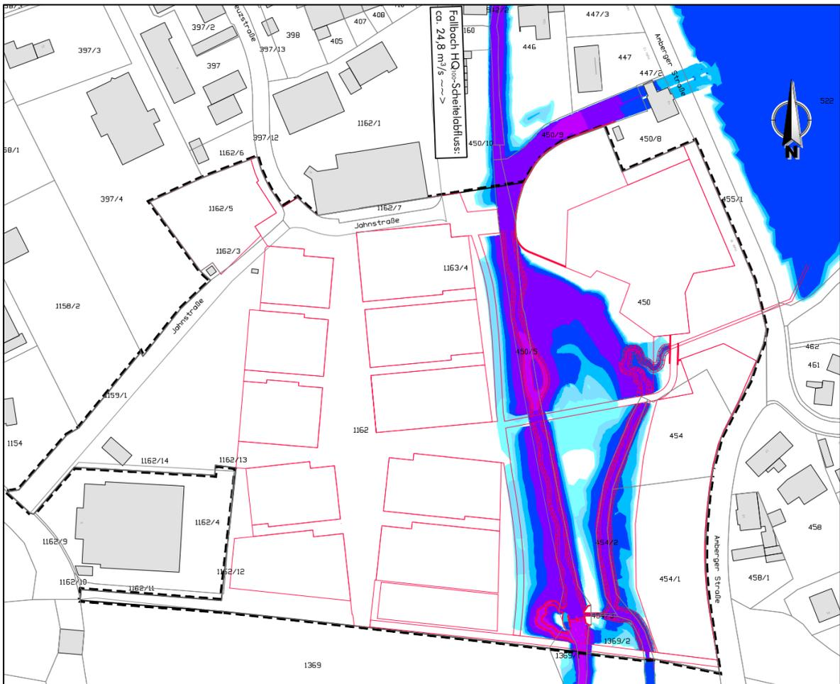
**Abbildung 5: Fließtiefen Planung Lastfall HQ<sub>100</sub>. Die neu bebauten Geländebereiche werden hochwasserfrei angelegt, der Überschwemmungsbereich des Fallbachs entsprechend begrenzt. Durch Neuanlage einer Flutmulde und Abflachen der Uferbereiche kann das Retentionsraumvolumen ortsgleich ersetzt werden. Rund 100 m südlich des Geltungsbereiches erfolgt die Anlage einer Fläche für den funktionalen Ausgleich.**
