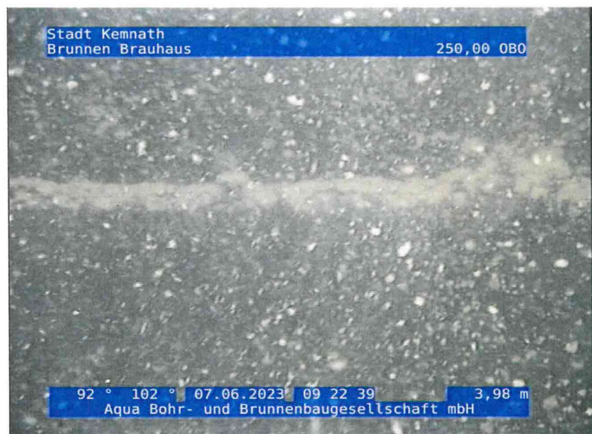
6, 00:03:42, 3.98m OK Filterrohr / eine Halbschale Filterschlitzze
