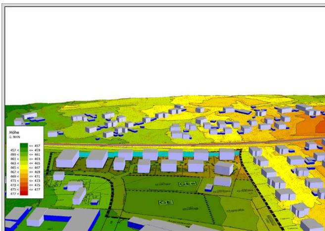
digitalen Daten /14/ entwickelt. Das Bebauungsplangebiet liegt im Norden bei ca. 460 m bis 464 m ü. NHN und 459 m bis 464,5 m ü. NHN im Süden. Die B 22 verläuft im Norden des Plangebietes auf ca. 464 m bis 468 m ü. NHN. Das digitale Geländemodell mit Bestands- und Plangebäuden sowie grafisch hinterlegtem B-Plan-Entwurf ist nebenstehend dargestellt.
